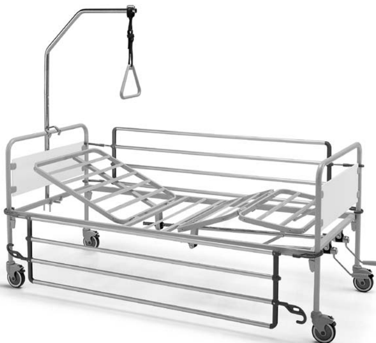
Fig. 3 Letto a 3 snodi, 4 sezioni (Art. A 5032) con accessori (Art. A 9042 asta sollevamalato - Art. A 9121 coppia sponde ribaltabili - Art. .../C1 Kit 4 ruote con freno indipendente)
